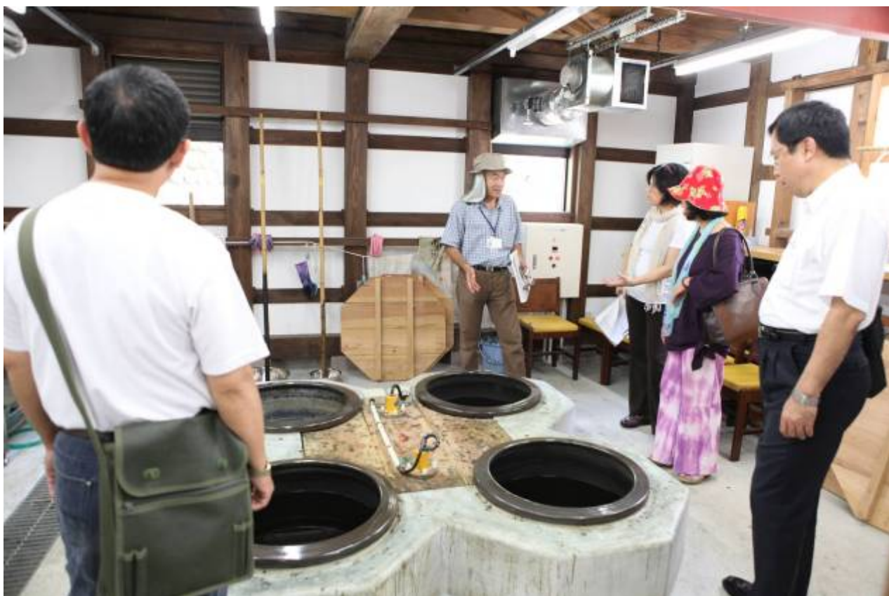
【圖 66】所長黑澤伸先生（左二）講解藍染工房設備—直徑 70cm 深 90cm 的「藍瓶」
